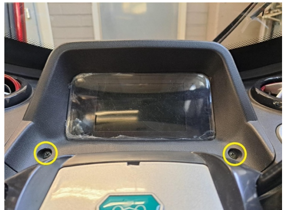
Irrota mittariston kiinnitysruuvit. (ristipäämeisseli ph2)
